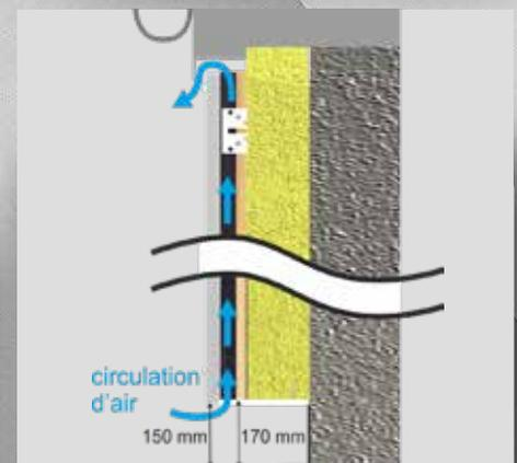
Bardage ventilé : circulation d'air lame d'air de haut en bas
