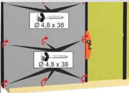
Utilisez des vis identiques avec rondelles d'étanchéité
